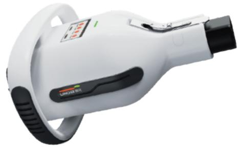
充放电数据采集分析仪分为国标交流和直流两款产品，分别对交流或直流的充放电电压、电流及导引控制信号进行数据采集、存储、分析、诊断和传输，可实现对充电时序的分析诊断，并显示充电信息及设备运行状态。
